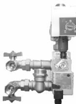
Sie sind zur Regelung der Heizleistung der Wassererhitzer bestimmt. Sie bestehen jeweils aus einer Dreigangpumpe, zwei Sperr-Kugelventilen und der Anschlussrohrleitung.
