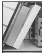
Die Einheiten der Baureihe DUPLEX werden standardmäßig mit Filtern der Filterklasse Coarse 60 % (G4) ausgestattet. Als Option können die Filter ePM10 50 % (M5) oder ePM1 55 % (F7) auf der Zu- oder Abluftseite mit der Senkung des externen statischen Drucks der Einheit um ungefähr 50 bis 100 Pa (sauberer Filter) in Abhängigkeit von der Luftdurchflussmenge, dem Typ der Einheit und der Luftverschmutzung installiert werden.
